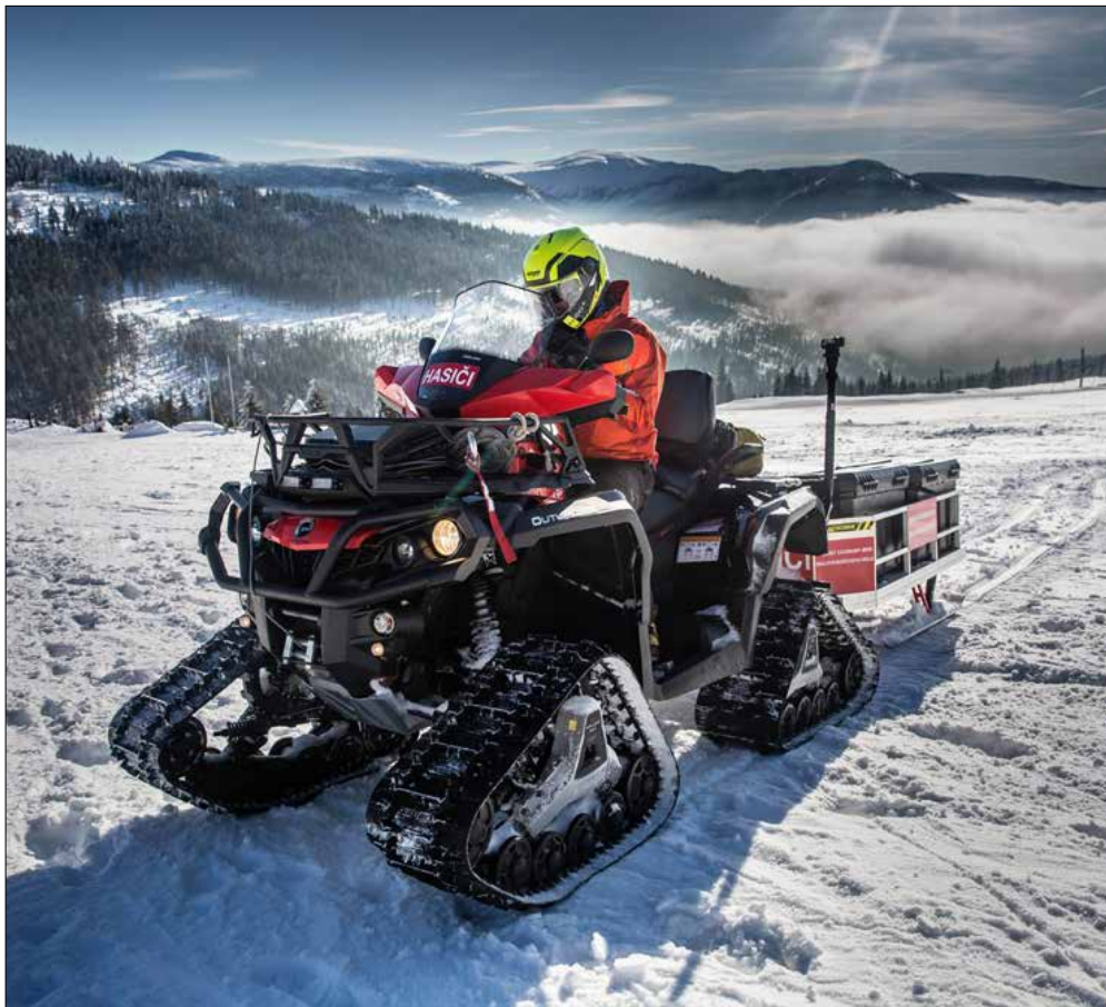
Pásové systémy a adaptéry dávají hasičským čtyřkolkám skvělou trakci při efektivním zásahu i v nejnáročnějším terénu. Foto Michal Fanta.
